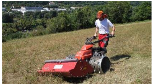
Bei leichterem Gelände mit flächigem Gehölznachwuchs können kleinflächig handgeführte oder ferngesteuerte Mulchgeräte eingesetzt werden.
